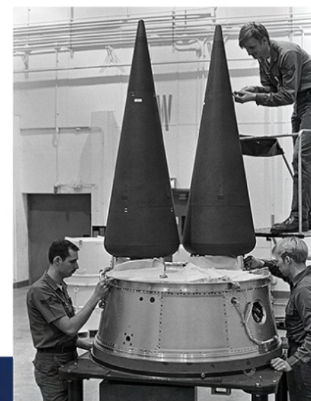
ミニットマンⅢの弾頭部。円錐状の物体がRV(再突入体)で、表面は再突入時に熱により溶解する。
