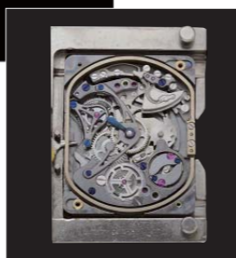
ムーブメントの裏側で、モディファイを受けたゴングとハンマーの形状などミニッツリピーターの構造が見える。6時位置がリピーター用のパレルで、その右側が2枚のウイングにプラチナを採用したサイレント・レギュレーター。
