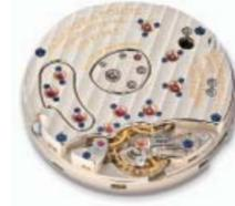
直径30.4mm、厚さ5.9mm。部品点数365。53石。毎時2万1600振動。パワーリザーブ約72時間。3/4プレート。二重香箱。時、分、ストップセコンド機能付きスモールセコンド。大型日付表示。パワーリザーブAUF/AB表示。
