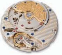
直径30.4mm、厚さ5.4mm。部品点数476。43石。毎時2万1600振動。パワーリザーブ約46時間。自動巻き。3/4プレート。SAX-O-MAT両方向巻き式3/4スケールローター。時・分・スモールセコンド。ゼロリセット機構による秒針位置合わせ機能。年次カレンダー（大型日付表示、曜日、月表示）。ムーンフェイス。
