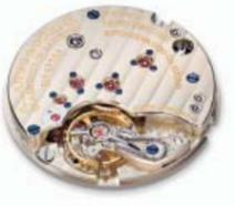
直径25.6mm、厚さ3.2mm。部品点数164。21石。毎時2万1600振動。パワーリザーブ約45時間。3/4プレート。時、分、ストップセコンド機能付きスモールセコンド。
