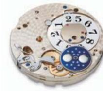
直径30.4mm、厚さ5.9mm。部品点数398。54石。毎時2万1600振動。パワーリザーブ約72時間。3/4プレート。二重香箱。時、分、ストップセコンド機能付きスモールセコンド。大型日付表示。パワーリザーブAUF/AB表示。122年に1日の誤差のムーンフェイス表示。
