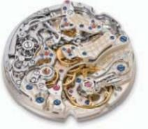
直径30.6mm、厚さ7.9mm。部品点数451。46石。毎時1万8000振動。パワーリザーブ約60時間。自社製ヒゲゼンマイ。フライバック、プレジジョン・ジャンピング・ミニッツカウンター搭載クロノグラフ。時、分、ストップセコンド機能付きスモールセコンド。大型日付表示。パワーリザーブAUF/AB表示。
