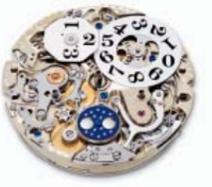
直径32.0mm、厚さ8.0mm。部品点数556。45石。毎時1万8000振動。パワーリザーブ約36時間。自社製ヒゲゼンマイ。フライバック、プレジジョン・ジャンピング・ミニッツカウンター搭載クロノグラフ。永久カレンダー（大型日付表示、曜日、月、閏年表示）。ムーンフェイス。デイ・ナイト表示。時、分、ストップセコンド機能付きスモールセコンド。
