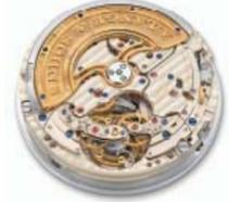
直径34.1mm、厚さ7.8mm。部品点数624。68石（+1ダイヤモンド）。毎時2万1600振動。パワーリザーブ約50時間。自動巻き。自社製ヒゲゼンマイ。衝撃吸収型サスペンション方式センターローター。時、分、ストップセコンド機能付きトゥールビヨン。スモールセコンド。永久カレンダー（大型日付表示、レトログランド式曜日表示、月表示リング、ムーンフェイス、閏年表示）。デイ・ナイト表示。
