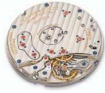
直径34.1mm、厚さ4.7mm。部品点数397。42石。毎時2万1600振動。パワーリザーブ約72時間。3/4プレート。自社製ヒゲゼンマイ。時、分、ストップセコンド機能付きスモールセコンド。大型日付表示。パワーリザーブAUF/AB表示。
