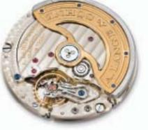
直径30.4mm、厚さ4.6mm。部品点数268。31石。毎時2万1600振動。パワーリザーブ約72時間。自動巻き。3/4プレート。自社製ヒゲゼンマイ。衝撃吸収型サスペンション方式センターローター。時、分、ストップセコンド機能付きスモールセコンド。第2時間帯表示。デイ・ナイト表示兼用24時間表示。
