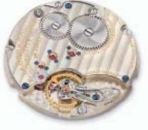
直径28.0mm、厚さ2.9mm。部品点数167。21石。毎時2万1600振動。パワーリザーブ約72時間。3/4プレート。自社製ヒゲゼンマイ。時、分表示。
