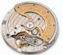
直径30.4mm、厚さ3.7mm。部品点数209。31石。毎時2万1600振動。パワーリザーブ約72時間。自動巻き。自社製ヒゲゼンマイ。衝撃吸収型サスペンション方式センターローター。時、分、ストップセコンド機能付きスモールセコンド。
