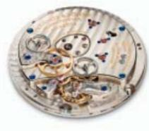
直径34.1mm、厚さ6.65mm。部品点数417。54石。毎時2万1600振動。パワーリザーブ約72時間。3/4プレート。二重香箱。時、分、ストップセコンド機能付きスモールセコンド。大型日付表示。パワーリザーブAUF/AB表示。ホームタイム（大型日付表示が連動）。24都市リング付き第2時間帯表示。ホームタイムと第2時間帯それぞれにデイ・ナイト表示。
