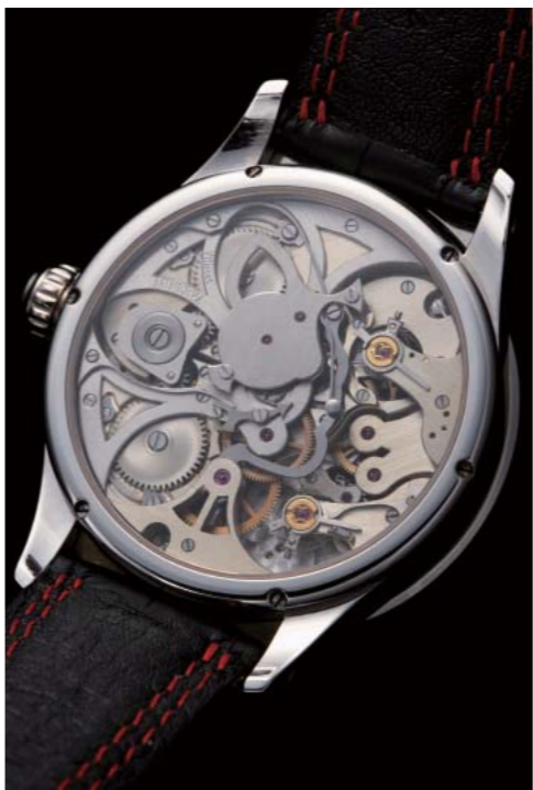
時刻表示用の通常の時計（1万8000振動、パワーリザーブ約100時間）と、15分間の積算計を装備したクロノグラフ用の計時時計（36万振動、パワーリザーブ45分）を装備したCal.MB TW02。サイズは38.40mm×10.60mmで、472個のパーツが使われる。ベースプレートとブリッジはジャーマン・シルバーで、ステムの上下にそれぞれのバレル、その反対側にふたつのテンプが置かれる。
