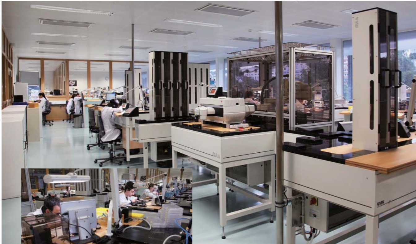
「マリントクロノメーター・マニユファクチュール」に搭載されるCal.UN118は、現在14名が各工程に分かれ、順次ムーブメントを組んでいる。この設備では1日100個までの組み立てが可能という。
