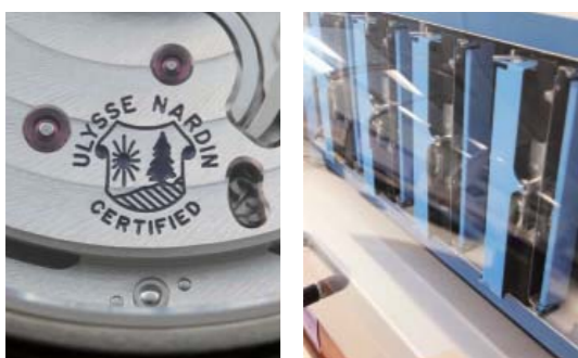
独自の精度および技能検定である「ユリス・ナルダン検定」は、現在はCal.118のみが検査対象となっている。合格したムーブメントにはユリス・ナルダンのマークの下に「CERTIFIED」の文字が刻まれる。
