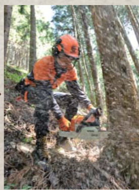
伐木を実演していただいた。まず木を倒す方向を確認し、頭のなかで倒れる様子をシミュレーションする。続いてチェーンソーを入れる部分をチェックし、まず下に水平に、続いてその水平線に向けて上から斜めに切っていく。一気に切り倒すのではなく、倒れる方向を見定めながら慎重に切っていく様子がうかがえた。
