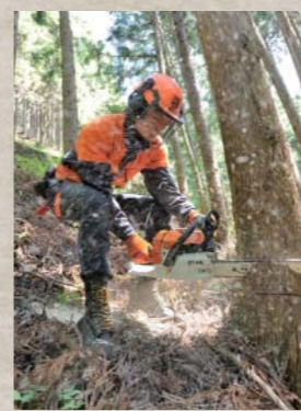
伐木を実演していただいた。まず木を倒す方向を確認し、頭のなかで倒れる様子をシミュレーションする。続いてチェーンソーを入れる部分をチェックし、まず下に水平に、続いてその水平線に向けて上から斜めに切っていく。一気に切り倒すのではなく、倒れる方向を見定めながら慎重に切っていく様子がうかがえた。
