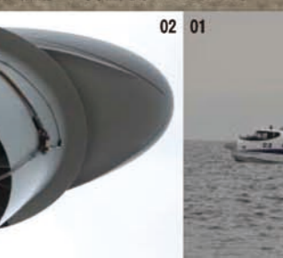
01:US-2の試験機。今はもう上の写真のように塗り直され、5機のうちの1機として活躍している。02:先端にはレーダーを内蔵している。胴体に沿ってシェードが付いているように見えるが、これは着水時に飛び散るしぶきによって、エンジンや機体が損傷するのを防ぐための蒸気波消し装置。着水時のしぶきはシェードの中で回って下に逃げる。実外重要な役目を果たしているのだ。またロープが付いているのが見えるが、これは碇を下ろしたり、保留するときに使用する。ただ、あまり使用することは無いとのこと。03:飛行艇ならではの車輪の格納。これぞ水陸両用のかたちである。
