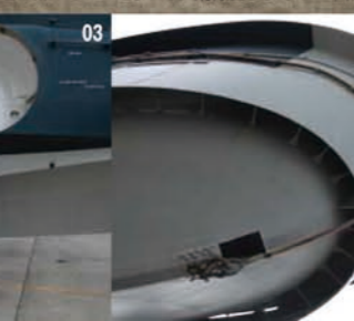
01:US-2の試験機。今はもう上の写真のように塗り直され、5機のうちの1機として活躍している。02:先端にはレーダーを内蔵している。胴体に沿ってシェードが付いているように見えるが、これは着水時に飛び散るしぶきによって、エンジンや機体が損傷するのを防ぐための蒸気波消し装置。着水時のしぶきはシェードの中で回って下に逃げる。実外重要な役目を果たしているのだ。またロープが付いているのが見えるが、これは碇を下ろしたり、保留するときに使用する。ただ、あまり使用することは無いとのこと。03:飛行艇ならではの車輪の格納。これぞ水陸両用のかたちである。
