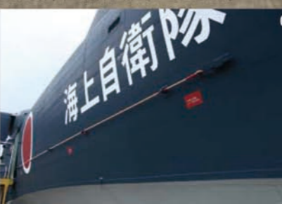
04:05:左舷の前方に設置された前方監視赤外線(FILIR)装置。夜間捜索時などに使用される。引き込み式ターレットで装置され、捜索時以外は格納されている。06:左舷の後の方の胴体に沿ってロープが設置されている。これは着水中、救助時に救助口から落ちてしまい、流されそうになった人が掴まるためのもの。万が一の備えであるLIFE LINEだ。07:飛行中のUS-2。なんとも頼もしい姿である。08:帰還後、ウォッシュラックに直行するUS-2。まとわりついた海水をきっちり洗い流すことは、機体を良好に保つために必ずやらなければならないことのひとつ。
