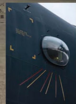
両サイドに視界が広くとれるパルキャンピーを配している。キャンピーの下のラインは、着水できず、海上の遭難者にボートなどを投下する際の目安。
