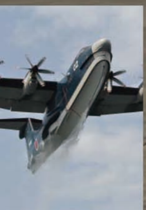
100km/h以下の超低速で離水するUS-2。その直後の姿がこれ。胴体の下にまとわりついた海水を落とすつつ大空へ飛び立つ。
