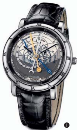
「アストロラビウム ガリレイ」の3部作第一弾は、古代の天文観測機器を腕時計で再現。写真は2003年にリニューアルされた現行モデル。地球から見える太陽、月、星の位置や月齢、月食と日食の日時を表示する。自動巻きCal.UN-99。ケース径41mm。
