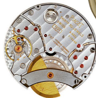
1958年発表の自動巻きの12P(30石、毎時1万9800振動、パワーリザーブ約40時間)は236部品で構成され、直径28.1mm、厚さ2.3mm。オフセンターに24Kゴールドのマイクロローターを備え、薄さを実現した。
