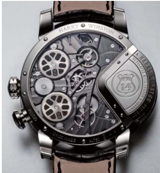
手巻き式のCal.HW4601(124石、2万8800振動)を望む。ベースは3バレルでシリシウム製のヘアスプリングを搭載したブランパンCal.13RO。そのバレルをひとつ取り外し、残りのひとつは通常の時計(パワーリザーブ約68時間)、もうひとつはファンクション用(ディスク往復5回分)とした。
