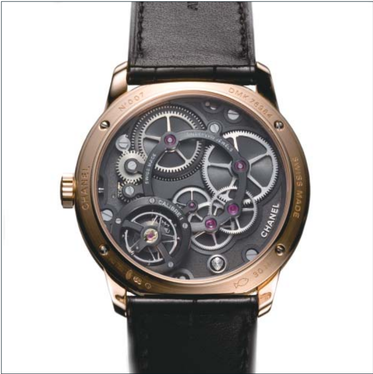
サファイアクリスタル・バックを通して見る手巻きムーブメントの「CHANEL キャリバー1.ジャンピングアワー」（直径40.7mm、厚さ10.4mm、30石、毎時2万8800振動、パワーリザーブ約3日間）。170個の部品で構成され、シャネルを象徴するカラーであるブラックのADLC加工が施されている。テンプレートの右側にあるパーツにはリュウズと同様に力強さとパワーを象徴するライオンのエンブレムが刻まれる。
