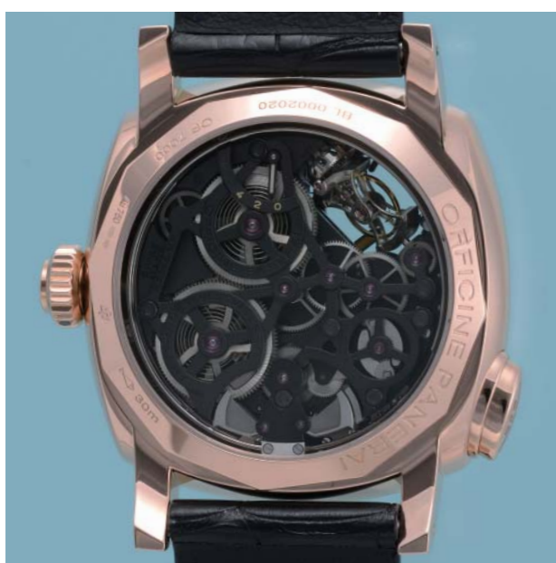
シースルー・ケースバックが採用されたミニッツリピーター・カリオン・トゥールビヨンGMTモデル。30秒で1周するトゥールビヨンはテンプの回転軸に対して垂直にまわる。その右隣は4日間のパワーリザーブ計で、ムーブメント周囲にはゴングとハンマーが見える。
