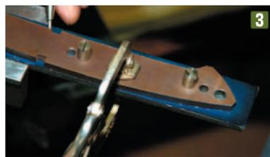
あけた穴にファスニングボルトをセットして、マスターの外形を鋼材にマークする。ボルトをセットしておけば、ケガキの途中でバイスグリップが緩んでも、マスターと鋼材がズレ心配はない。
