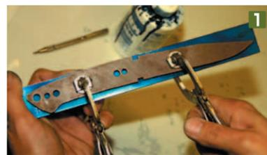
鋼材にブルー・インクを塗り、バイスグリップでしっかりとマスターを固定する。正確なナイフを製作するためには、正確なケガキが重要。設計どおりのナイフを作るための第一歩だ。
