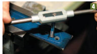
外形をマークしたら、鋼材をテーブルバイスに固定してテーパ加工用の穴に、タップで雌ネジを切る。鋼材が固定しやすい形のうちに、ネジを加工した方が安全だ。
