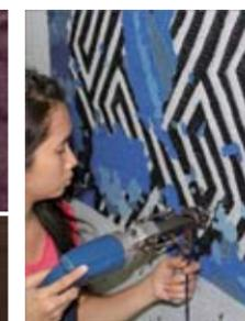
基布に専用マシンでパイルを打ち込むハンドタフト製法で描かれる模様。カービング加工による立体感と陰影も美しい。
