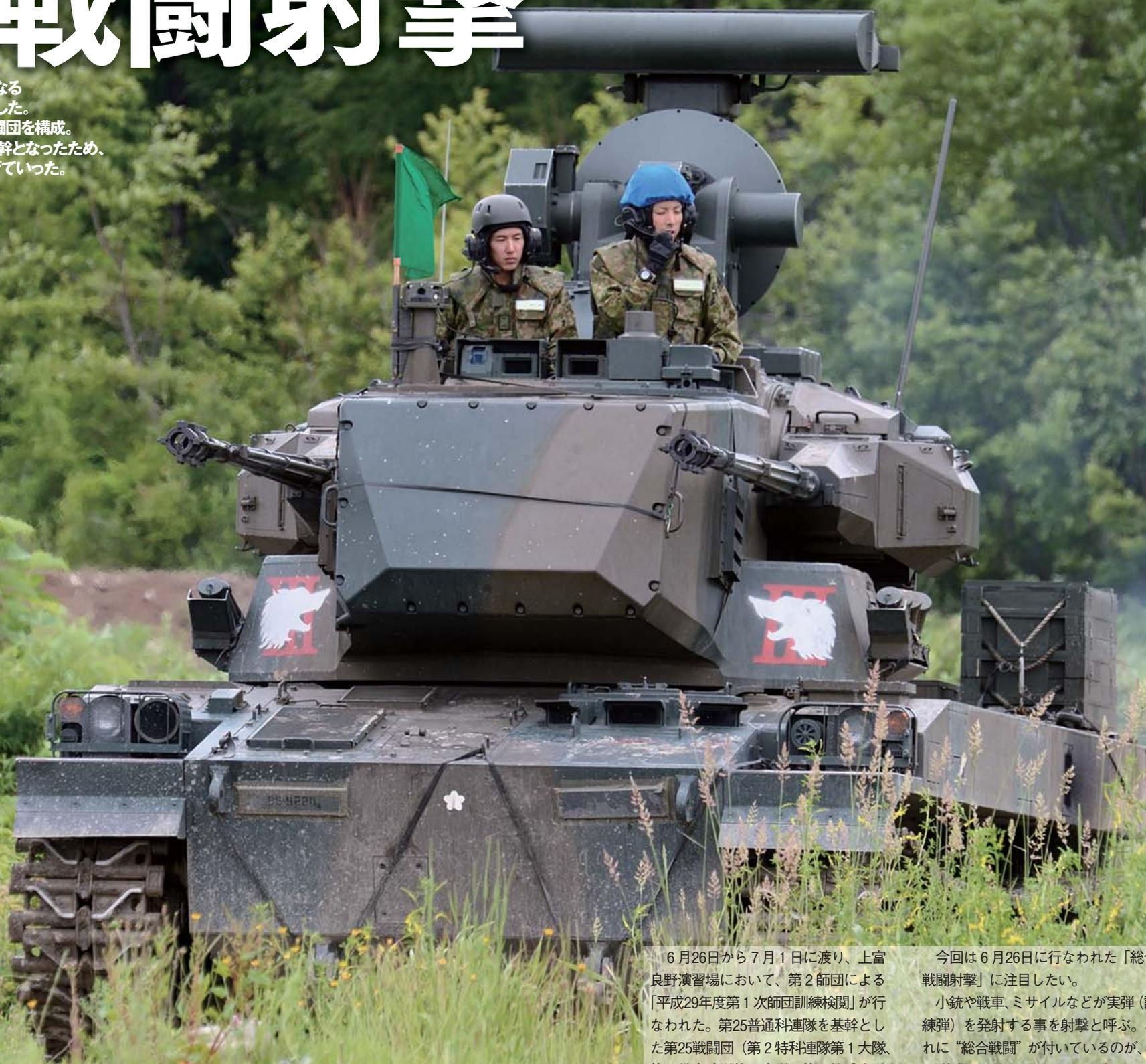
第2高射特科大隊に配備されている87式自走高射機関砲。敵の航空機やミサイルを迎撃するための装備であるが、砲身を水平に向けて射撃すれば、敵戦車や装甲車とも戦う事ができる。
