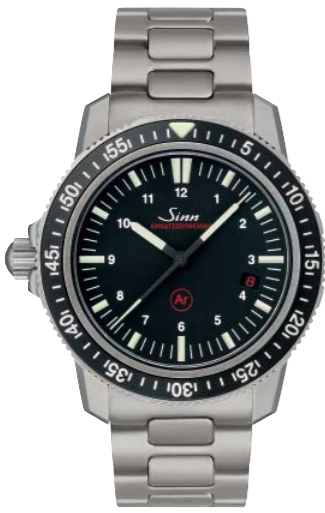
「EZM3」。2001年発売。ドイツ警察特殊部隊に制式時計として採用された。直径41mm、厚さ13mmのステンレススチール・ケースに自動巻きのETA Cal.2824-2(25石、毎時2万8800振動、パワーリザーブ約38時間)を搭載する。インナーケース、ムーブメント・ホルダー、裏蓋、文字盤に軟磁性素材の軟鉄を用いて80000A/mまでの耐磁性を備える。50気圧防水。価格35万6400円。
