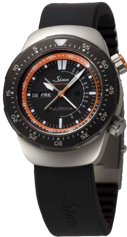
直径44mm、厚さ14mmの表面硬化処理を施したSSケースに自動巻きのETA Cal.2836-2(25石、毎時2万8800振動、パワーリザーブ約38時間)を搭載する。ベゼルは表面硬化処理を施したSSにブラックPVD加工を施す。着脱可能なシリコン・ストラップ装備。20気圧防水。時計、ポケットナイフ、ストラップの交換用ツール、予備のバネ棒を収納した特別ボックス付き。価格60万4800円。
