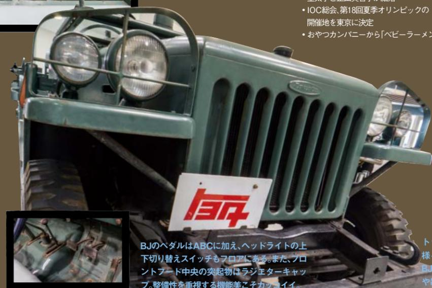
BJのペダルはABCに加え、ヘッドライトの上下切り替えスイッチもフロアにある。また、フロントフード中央の突起物はラジエターキャップ。整備性を重視する機能美こそカッコイイ。
