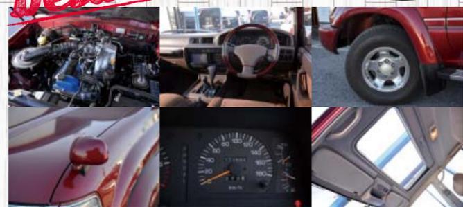
エンジンは1FZ-FE。総排気量4476ccから215PS/4600rpmの最高出力、38.0kgm/3200rpmの最大トルクを発生。余裕のクーリングがこなせる人気の高いエンジンだ。高級車ライクのインパネ周りは80の特長のひとつ。扱いやすいスイッチ類も魅力。タイヤサイズは275/70R16。中古車両はサイズアップやメッキタイプのホイールなどに換装されているパターンが多い。メーターは視認性に優れたアナログタイプ。タコメーターは左側に装備。サンルーフはシェードが付いたチルト&スライドオープンタイプ。
