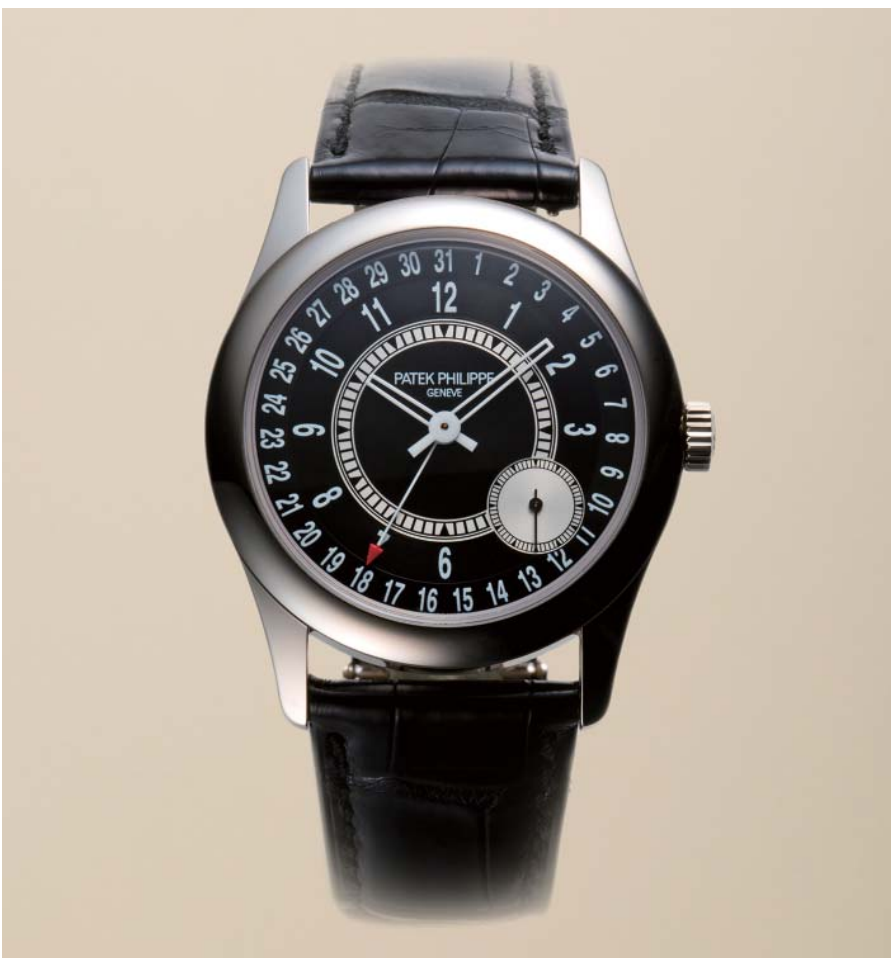
「カラトラバ Ref.6006」。直径39mmの18Kホワイトゴールド・ケースにマイクロローター式自動巻きのCal.240 PS C(27石、毎時2万1600振動、パワーリザーブ約48時間)を搭載する。4時30分位置にスモールセコンド、文字盤外周に日付表示を備える。サファイアクリスタル・バック。3気圧防水。価格334万円。
