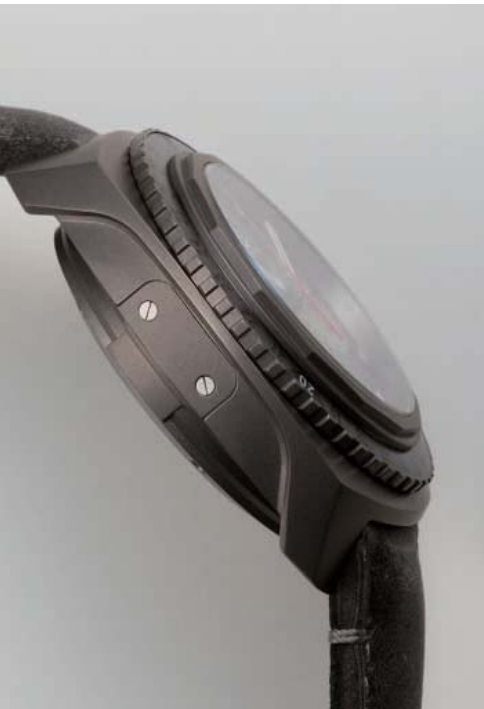
(右)「レイダー ビバーク 9000」直径48mmのチタニウム製ケースに、手巻きのCal.FL311 (21石、毎時2万8800振動)。パワーリザーブ約65時間)を搭載する。ベースとなっているキャリバーは、エテルナ製EMC3903M。気圧計測用金属カプセルをセンターに備えるモジュールを設置するのに、このキャリバーが適していたという。極限環境に於いても視認性が確保できるよう、文字盤を広く取り、スーパールミノバを塗布したための時分針やインデックスを採用している。ケースの質感や色調に合わせた、ウシ科のレイヨウの革を用いたアンテロープレザーストラップがセットされている。3気圧防水。価格91万8000円。 (上)ケース左サイドのネジ止めされたプレートでカバーされた箇所、直径約3mmの吸気口が設けられている。プレート脇のベントから、吸気口を通じて内部に空気を取り込むことで、密封カプセルが膨張／収縮し、気圧と高度を計測できる。この吸気口には、特殊な疎水性微細穿孔膜が取り付けられ、空気は通しながら、水分や埃を通さない工夫が施されている。これにより、3気圧の防水性が実現された。
