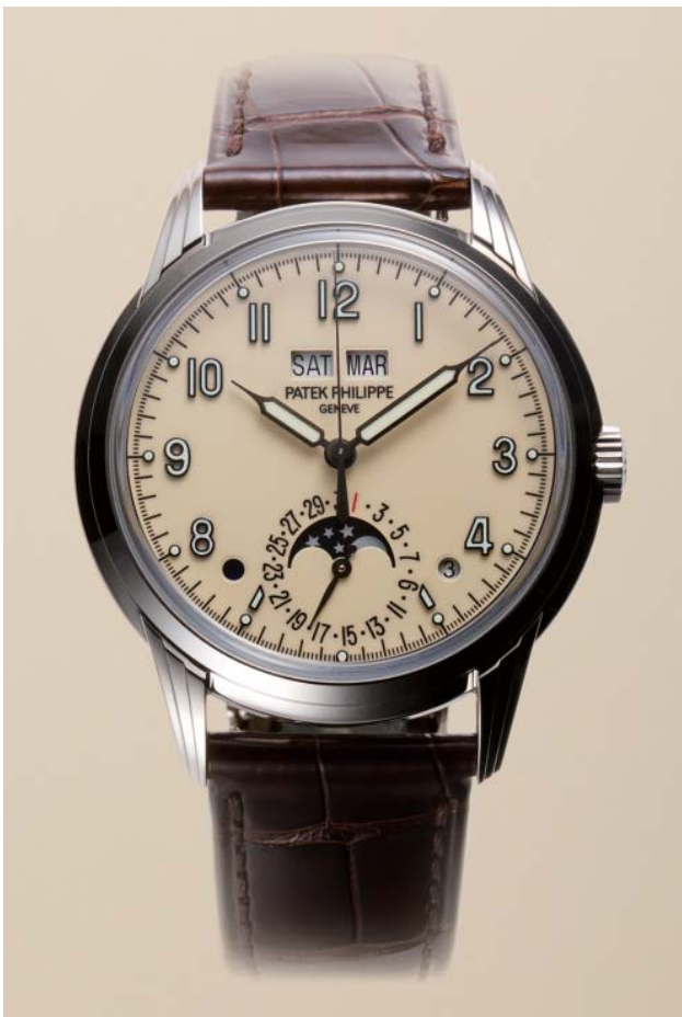
「永久カレンダー Ref.5320」。直径40mmの18Kホワイトゴールド・ケースに自動巻きのCal.324 S Q(29石、毎時2万8800振動、パワーリザーブ約45時間)を搭載する。クリーム色のラッカー文字盤の12時位置の小窓に月と曜日表示、6時位置にムーンフェイズと日付、4時30分位置に閏年表示、7時30分位置に昼夜表示を備える。サファイアクリスタル・バックと交換可能なフル・バックを付属。3気圧防水。価格902万円。
