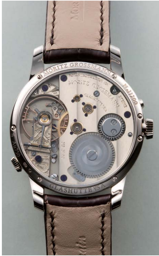
洋銀製の2/3プレートを使った手巻き式のロー・ビート・ムーブメントには、14.2mmの大きなテンワとフィリップ・カーブをもつヘア・スプリング、さらに特徴的なゴールド・シャトン留めが採用される。
