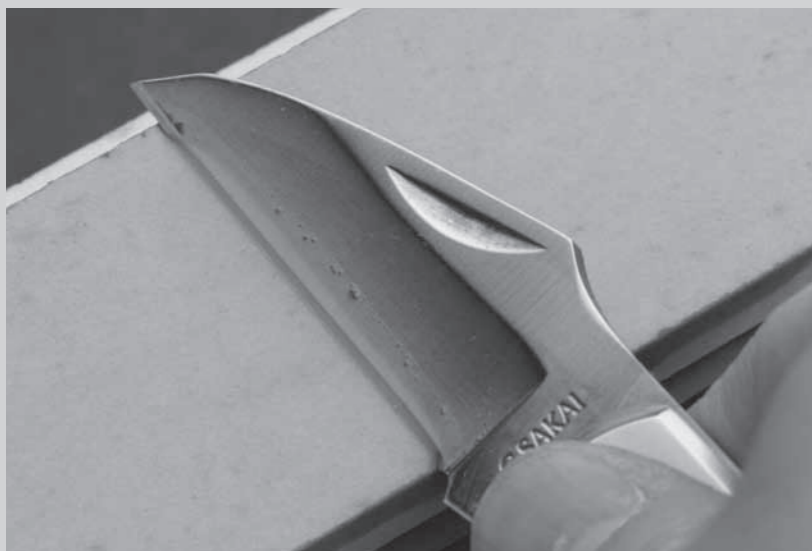
砥石の研削面にエッジベベルを当て、エッジ方向にズラした時、水やオイルがブレイド・ベベルに上がった角度が、エッジ角の基本だ。
