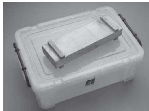
砥石をしっかりと固定でき、しかも容器に溜めた水がいつでも使える。砥石を正しくつかうための工夫、使いやすくするための工夫が、上手なシャープニングの第一歩だ。
