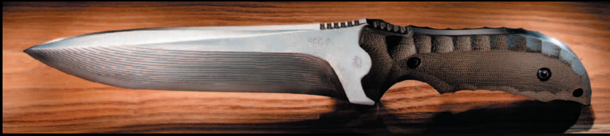
モンスーン G 全長306mm、ブレイド長180mm、ブレイド材SPG-2積層鋼(SPG-2をステンレスとニッケルで挟んだ鋼材)、ハンドル材グリーンキャンバスマイカルタ、価格78,000円。 Monsoon G 強度が求められるブレイド先端部分がハマグリ刃、後ろ半分が使い易い薄刃仕様になる。削り名人キクさんならではの1本。
