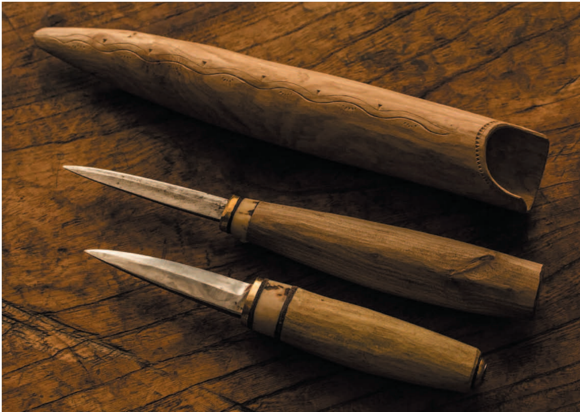
井丸さん手製のカービングナイフ。白紙材の鋼に新幹線のレール鋼などを積層させた地鉄を鍛接。木のハンドルやさやももちろん自作だ。販売もしている。
