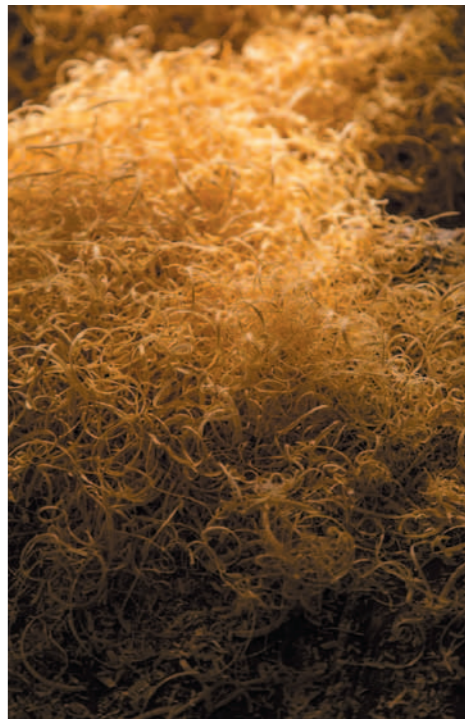
足踏み轆轤の削り屑。回転力もトルクも弱いので薄く細く少しずつ削る。生の木ならではのしっとりとした屑が出る。
