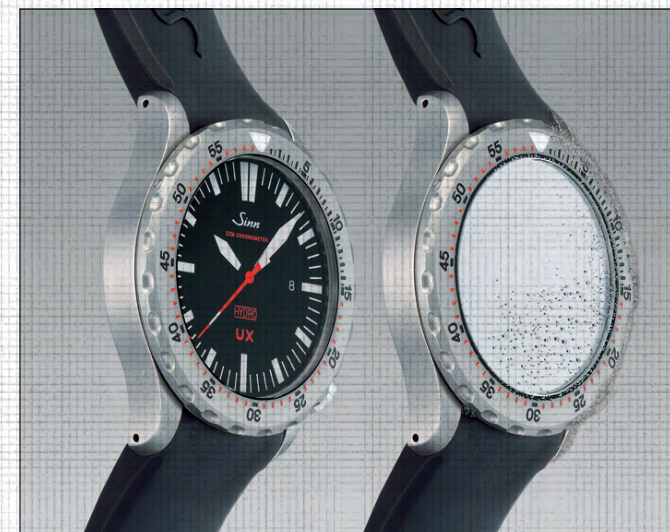
左の時計がシリコンオイル封入モデルで水中でもあらゆる角度から文字盤が視認できる。封入されていない右の時計の文字盤は45度以上の角度で鏡のように全反射してしまう。
