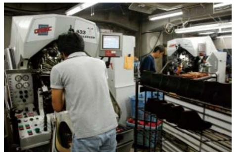
アッパーを木型に沿わせる「つり込み」にはイタリア製最先端マシンを2台活用。すべての木型の情報を瞬時に呼び出し形状を整えていく。
