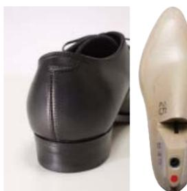
従来の木型より明らかに細くしかも内振りの設計だが、ボールジョイント部はわずかに高く設計。トゥキャップも短くしたのでそこに履きジワが入りにくくなった結果、鏡面磨きが割れるリスクも大幅に減少！
