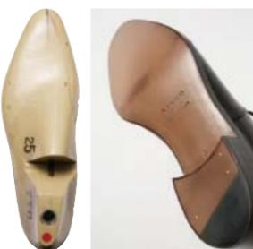
一般的な日本の紳士靴に比べ、ボールジョイント部の幅は適度にもたせつつも厚みを薄くするとともに一甲部分の抑えは強く設計。かかとの幅も小さめなので、緩急のバランスに優れた履き心地を得られる。
