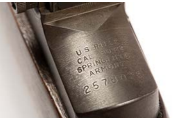
マーキング レシーバー後方に入れられた刻印。写真のM1ライフルはスプリングフィールド造兵廠（Springfield Armory）製のシリアルナンバー“2578028”で、1944年3月から6月の間に生産されたうちの1挺。ただし部品の一部が交換されており、生産当時とは状態が部分的に異なっている点に留意されたい。
