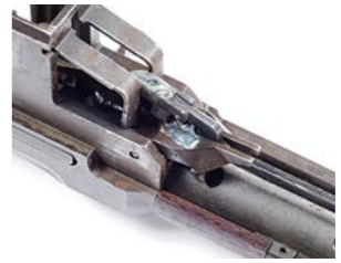
無可動実銃 今回撮影に使用したM1ライフルは発射機能を取り除いた実物、すなわち無可動実銃だ。安全のため薬室と銃身が所々に穴が開けられているほか、ボルトやパーツ同士を溶接加工し、一部パーツも部分的に切断、あるいは取り外す等の安全対策が施されている。
