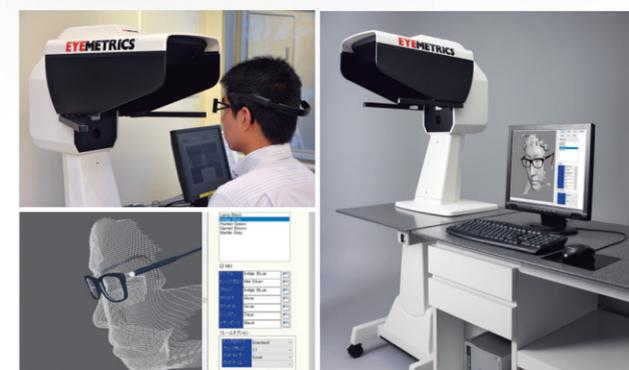
独自の計測機器「アイメーター」を使い、目や耳の位置、骨格などを0.1mm単位の精度で三次元的に計測。このデータに基づきパーツのサイズや鼻パッドの角度などを決定するため、最適な掛け心地が得られる。
