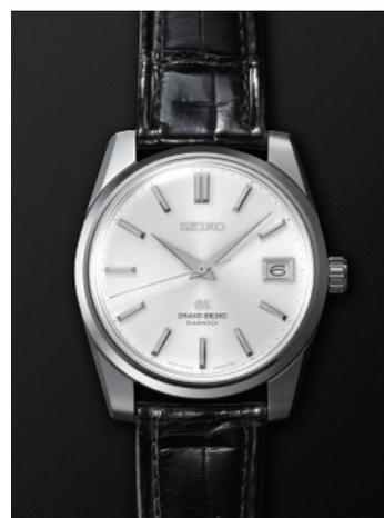
1964年に発売された57GS「セルフデーター」。初代のCal.3180に日付表示機構を追加したCal.5722を搭載し、リュウス操作で日付の修正が可能であった。またケースにパッキンを入れて裏蓋をねじリングで固定し現在の3気圧防水相当を実現。プレスレットや18KYGケースも作られた。
