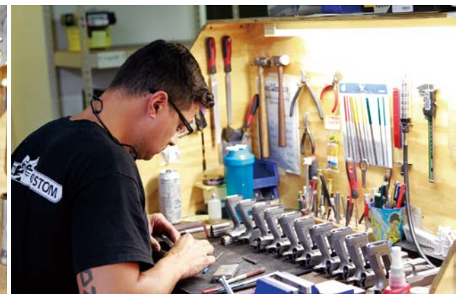
ガンスミスは各自が決まった作業を担当。こちらでは、A01シリーズのスライドとフレームのフィッティングを行なっている。
