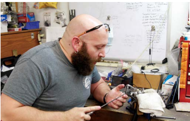
こちらはフレームに対してマグウェル加工を行なっている所。CZカスタムで働くガンスミスは、心底銃が大好きな人たちばかり。
