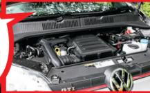
エンジンはup! 標準車の1.8 3気筒直噴ユニットをベースにターボ化したもので、最高出力、最大トルクともに標準車から大幅アップ。加速充分でとくに中回転域のパワーに優れ、乗り味は硬めで慣れも必要だが、より速く走らせたいというスポーティな気持ちに昇らせる。まさに男の本能を呼び覚ますMT車。あ、ますます妻を説得しにくい。
