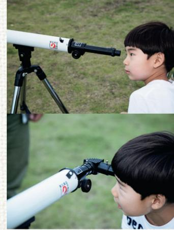
望遠鏡にそのまま接眼レンズを装着すると画面は上下左右が逆さまの倒立像になる。間に天頂ミラーをかませると上下は正しく左右は逆の裏像に。子どもが上から覗けない場合は天頂ミラーを横に回転させるとよい。
