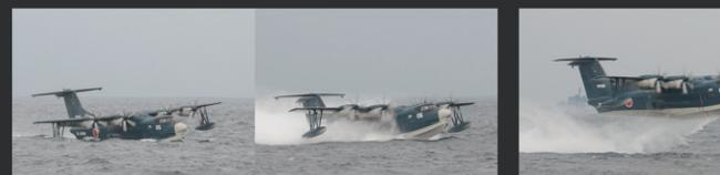
操作系統をコンピュータ制御することで安全性・操作性を向上させ、高耐波性技術や極低速離着水技術などの搭載で、悪天候時の離着水もスムーズに行える。
