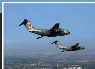
戦後初めて日本で開発された中型輸送機で、防衛庁技術研究本部と日本航空機製造が開発を行い、川崎重工業が製造を担当。1970年に初飛行した。
