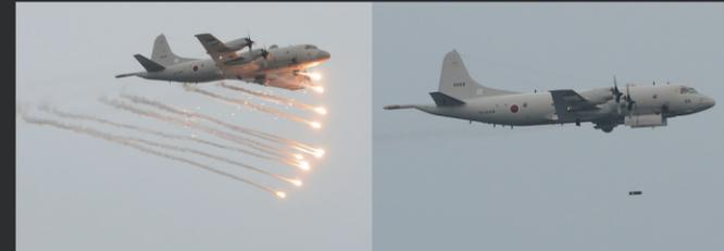
地上設備とリンクした高度な潜水艦の搜索・評定能力を持つP-3C。写真左は赤外線誘導ミサイルを避けるためのフレア放出飛行。同右は短魚雷投下のデモンストレーション。
