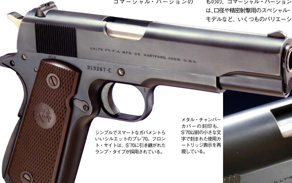
シンプルでスマートなガバメントらしいシルエットのプレ'70。フロント・サイトは、S'70に引き継がれたランプ・タイプが採用されている。
