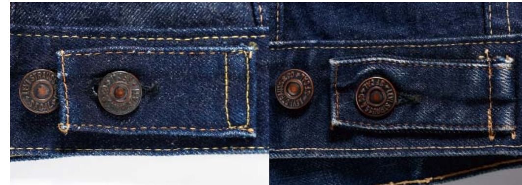
通常、アジャスターは写真左のようにボックス型に縫われて取り付けられているが、 ボタン裏Oの工場は巻き込んで取り付けられている(写真右)。 Normally, adjusters were sewn in the box-like shape, as shown in the photo on the left, yet the factory indicated as "O" on the back of buttons convoluted them to sew(photo on the right).
