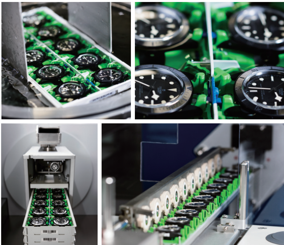
ジュネーブの自社工房内にマスター クロノメーターの検査設備が整えられた。上の写真の右は防水性能、左は6姿勢での精度誤差、下の右は1万5000ガウスの耐磁性、左は約70時間のパワーリザーブの検査。
