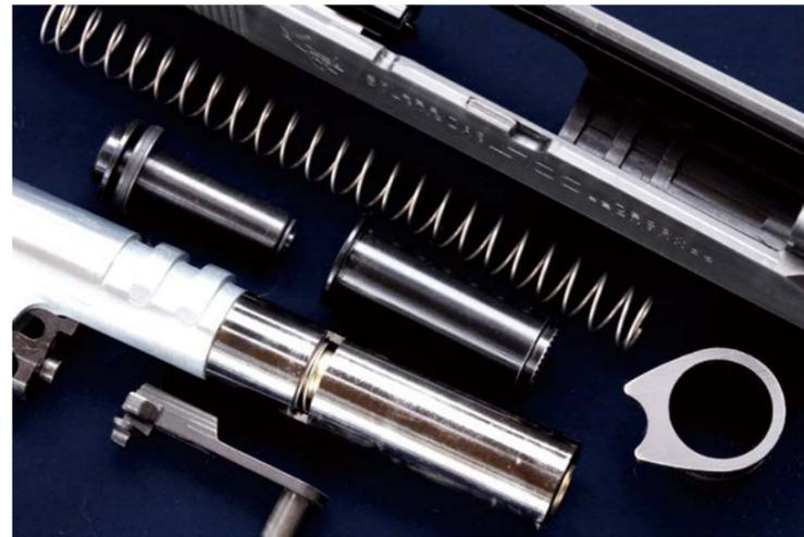
リコイル・システムはスタンダードなガバメント・スタイル。衝撃を吸収しつつ、スライド蹴り返すハイスピード・バッファも採用されている。スライドストップ・ノッチは、変形防止用のスチール・パーツを埋め込んだバージョン3仕様だ。
