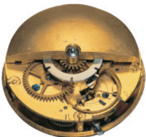
アブラムールイ・ペルレは1777年に今日のセンターローター式の元祖ともいえる自動巻き機構を装備したムーブメントを発明した。
