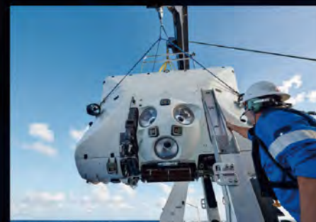
写真がリミティング・ファクター号。「ウルトラディープ」は同艇のロボットアームと記録物収集用ユニットに計3個が外付けされ、12時間の潜水後、破損もなく海上に戻された。
