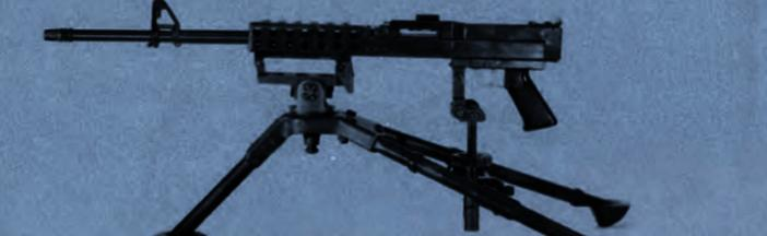
重機関銃としての使用を想定し、三脚に据えられたCMG-1。バットストックが取り付けられておらず、二脚も備えていないため非常にすっきりとした外觀となっている。
