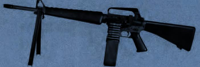
弾倉とベルト給弾の両方に対応した火力支援型のバリエーション。ベルト給弾の場合は120発入りの弾薬箱を使用する。重量は弾薬を装填していない状態で3.9kgと非常に軽量でありながらアメリカ軍には採用されなかった。
