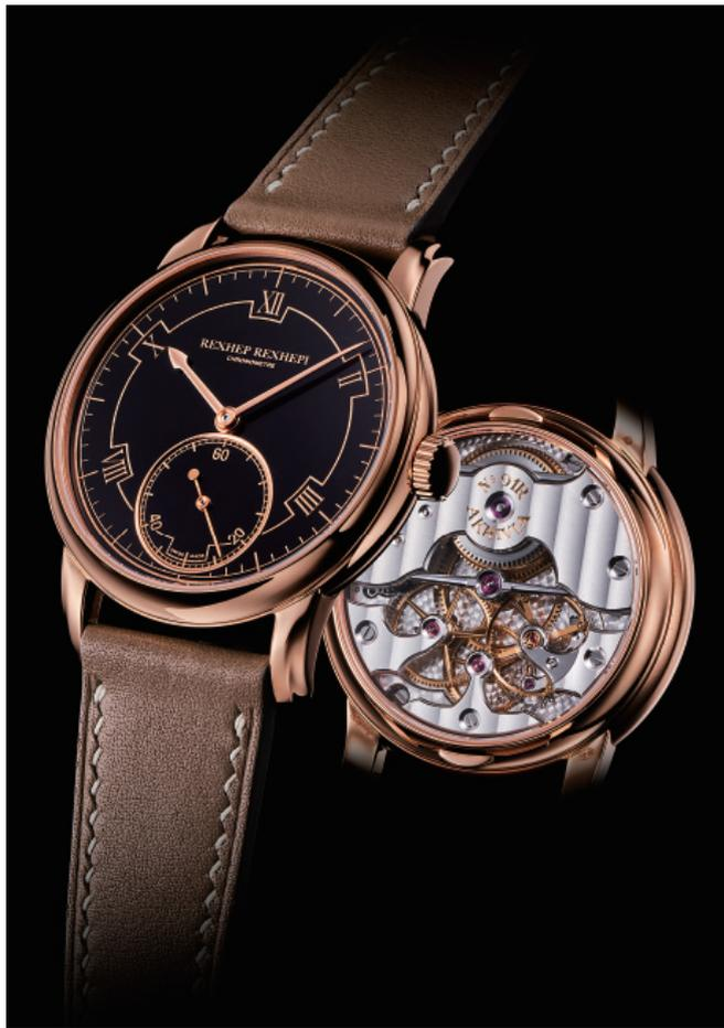
レジエピ氏は、2018年に右の写真にある「RRCC I」を発表し、文字盤に自らの名前を記した。3気圧防水の直径38.0mm×厚さ9.5mmの18Kローズゴールドのケースに手巻きのCal.RRCC-01 (19石、毎時1万8000振動、パワーリザーブ約100時間)を搭載する。Pt.950ケースも揃う。
