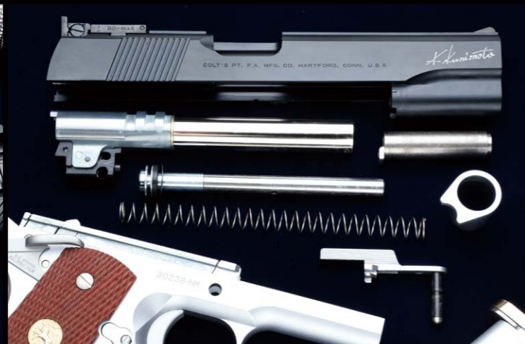
様々なアイデアを駆使して、スムーズなスライド・アクションとハイスピード・ブローバックを確保したスライド・グループ。リコイルスプリング・プラグは、スライドのレリーフカット部分全体でスプリング・テンションを受け、スライド・トップへの負担を軽減する独特のデザイン。モデルガンの時代から受け継がれる賢いスタイルだ。
