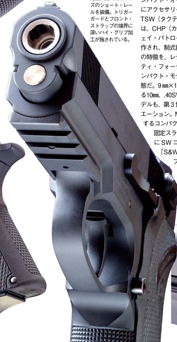
M4013TSWはM39を原点として第2、第3世代と引き継がれてきたS&Wダブルアクション・セミオートのもの、最終段階にあたる第3世代のコンパクト・オート。ダスト・カバーにアクセサリ・レールを装備するTSW (タクティカルSW) シリーズは、CHP (カリフォルニア・ハイウェイ・パトロール) からの要請で製作され、制式採用された「M4006」の特徴を、レディ・スミス、ショーティ・フォーティと発展してきたコンパクト・モデルに融合した最終形態だ。9mm×19と.45の中間に位置する10mm、.40SWカートリッジ用のモデルも、第3世代で採用されたバリエーション。M4013は.40SWを使用するコンパクト・オートだ。
