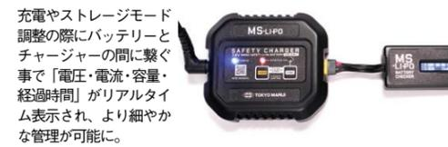
MS・Li-Poバッテリーにバッテリーチェッカーを接続すると現電圧が10秒間表示される。もう一度見たい場合は再接続すればOK。
