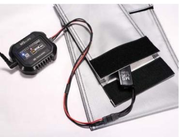
MS・Li-Poセーフティチャージャーは「CHARGE（＝充電）」の他、「STOR（＝ストレージモードへの調整）」にも対応。作業中はセーフティバッグ（小）にバッテリーを収納し開口部を底にしてさらに（大）に収める事で、万が一発火事故が起こった際の延焼を防げる。
